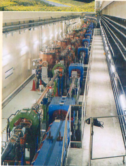
* 高いビーム電流を支える加速空洞
