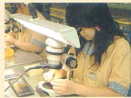
ムーブメント部材は目視で厳しく 検査される
