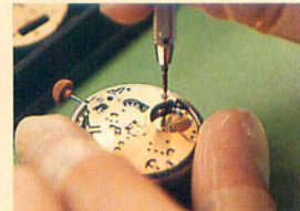
年差±5秒を実現した高性能ムーブメントの組み立ては、数ミクロン単位の 作業となる。指の震えもゆるめられない。
