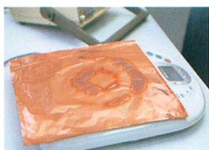
IHヒーターに銅箔を置くと瞬間に発熱する
