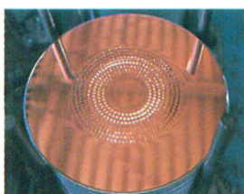
銅めっきを施した平板。密着性の高い下地処理によりプレス成形しても銅めっきが剥がれない
