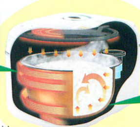
銅コイルに電流を流すと磁力線が発生し、釜が発熱する
