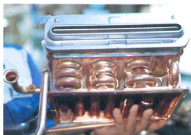
給湯器に組みこむ前の熱交換器
