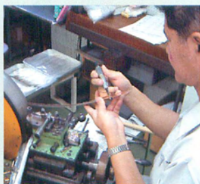
帯状の黄銅板をミクロン単位の精度で削り出す
