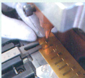
プレート加工形状もハーモニカの基本性能に大きく影響する
