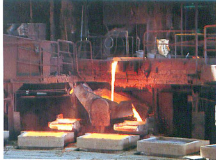
鋳銅機。オートメーション化が進み、必要最小の人員で操業されている
