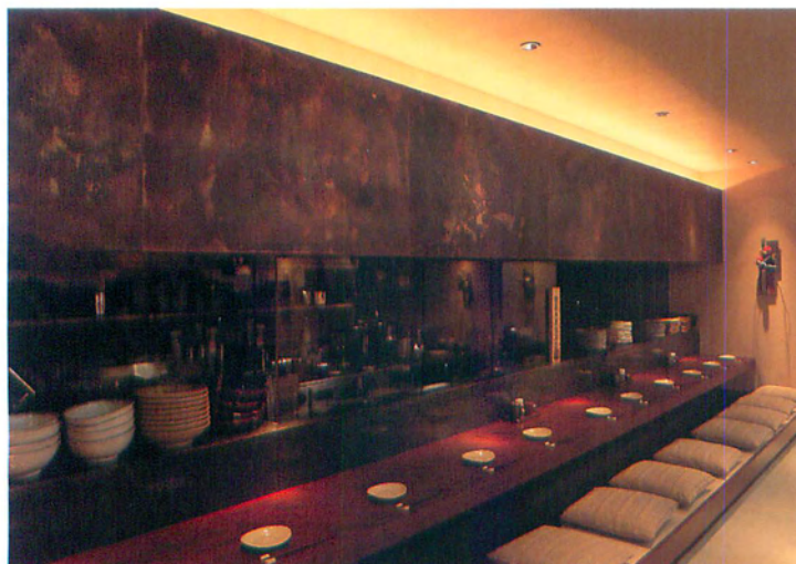
「鳥どり」 (東京・内幸町) 串焼き、鶏料理専門 職人の仕事が見れるオープンキッチンのカウンター上部には、0.35mm厚の銅製パネルが配されている
