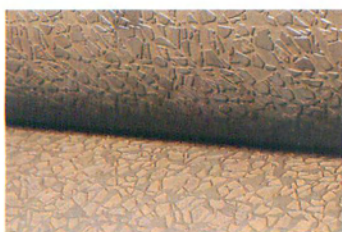
雄と雌のエンボスロールでプレスされ、精度の高い金属サイディング等が作られる
