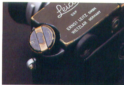
ライカM4のフィルム巻き戻しクラック。常に手に触れる部位なので、塗装が剥がれやすいが、それもまた「味」である。細かなところまでエンブレブされた刻印が美しい。クラシックカメラは無駄ともいえる細かなところまで、気をつけて製造されている。
