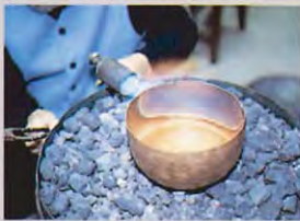
「焼きなまし」底の形が決まったら、底部分に水を張りバーナーで熱する。上部だけが焼きなましされる
