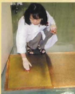
処置室の床に設置した銅板および黄銅板
